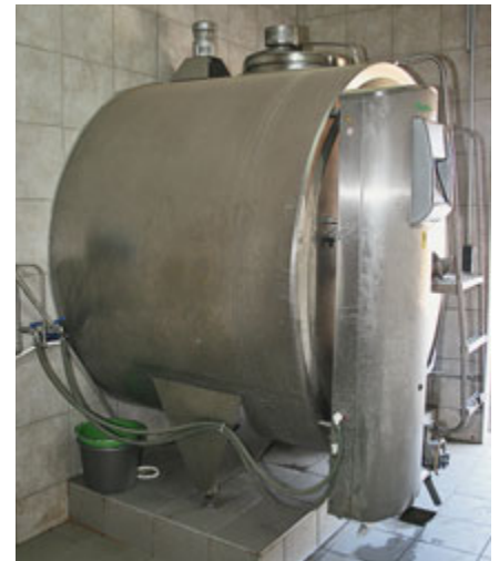
Der Tank lässt sich einfach reinigen, weil er nur zum Teil in die Milchammer ragt.
